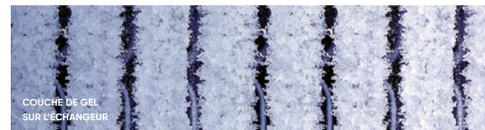
Cette fonction génère dans un premier temps une couche de givre sur l'échangeur de l'unité intérieure et extérieure, permettant de décrocher et d'emprisonner rapidement la saleté de la surface. Puis ce même échangeur est ensuite chauffé pour éliminer ce givre et éviter ainsi la croissance de bactéries.
